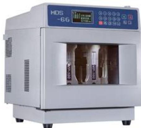
Рис. III.5. Лабораторные микроволновые печи, производства компании Henan Xinhang Microwave Technology Co., Ltd. (КНР), используемые для термической обработки прекурсоров при приготовлении гетерогенных катализаторов.
