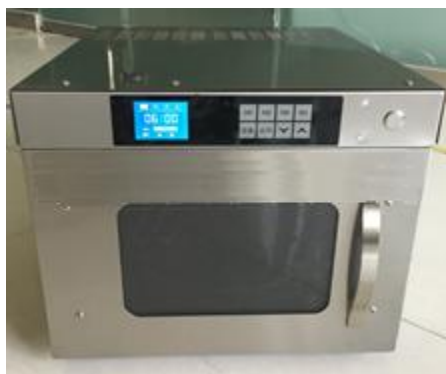
Рис. III.5. Лабораторные микроволновые печи, производства компании Henan Xinhang Microwave Technology Co., Ltd. (КНР), используемые для термической обработки прекурсоров при приготовлении гетерогенных катализаторов.
