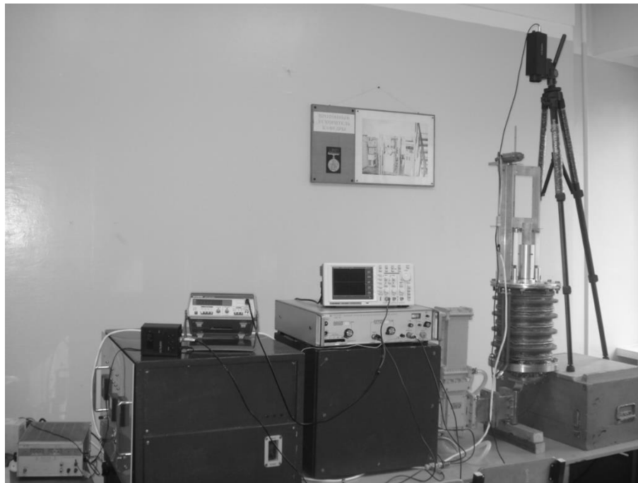
Рис. III.7. Вид экспериментальной СВЧ-установки теплового воздействия на полупроводники и несовершенные диэлектрики.
