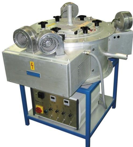
Рис. III.6 Лабораторные микроволновые печи МКЕ с поддержкой двух СВЧ-частот 2,45 и 5,8 ГГц
