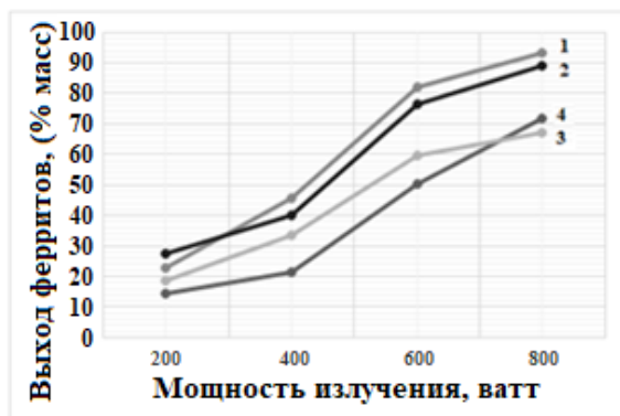
Рис. V.6. Зависимость выхода феррошпинели: 1- \text{CoFe}_2\text{O}_4 , 2- \text{NiFe}_2\text{O}_4 , 3- \text{CuFe}_2\text{O}_4 , 4- \text{ZnFe}_2\text{O}_4 от мощности СВЧ излучения. Время экспозиции образцов 15 мин.
