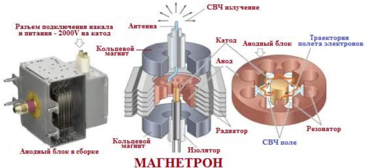
Рис. III.2. Устройство магнетрона
