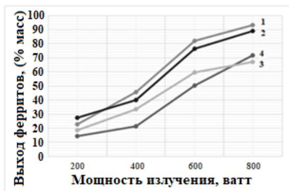
Рис. V.6. Зависимость выхода феррошпинели: 1-CoFe<sub>2</sub>O<sub>4</sub>, 2-NiFe<sub>2</sub>O<sub>4</sub>, 3-CuFe<sub>2</sub>O<sub>4</sub>, 4-ZnFe<sub>2</sub>O<sub>4</sub> от мощности СВЧ излучения. Время экспозиции образцов 15 мин.
